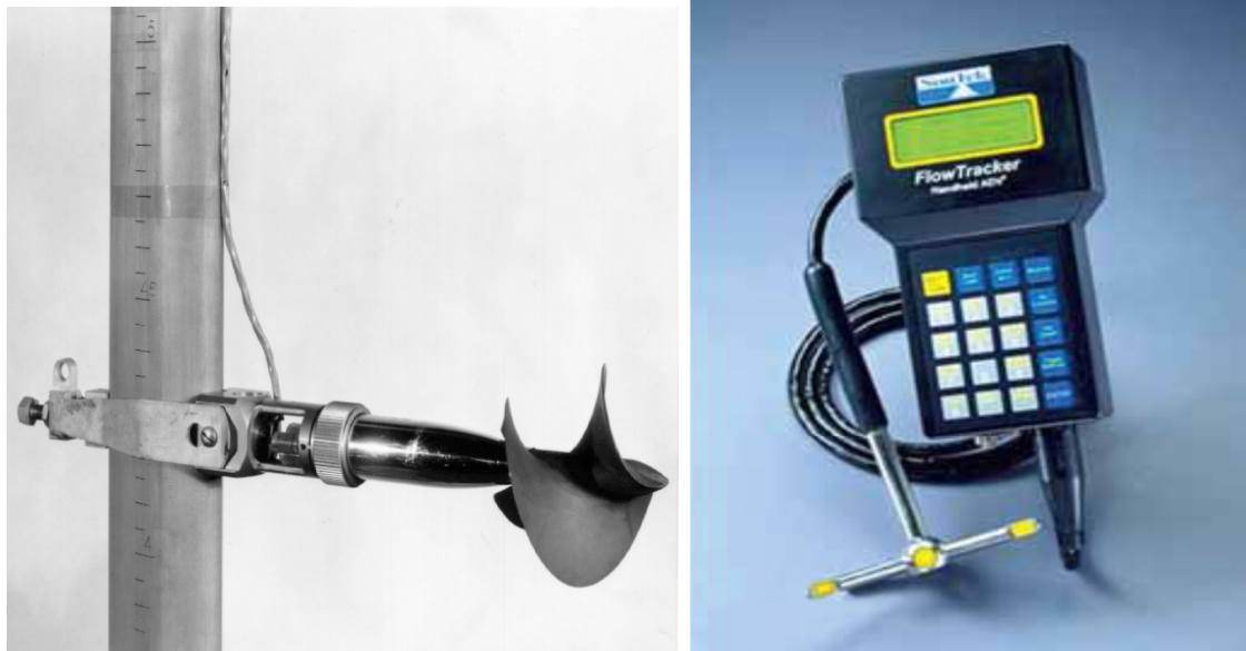
Joonis 1.1. Hüdromeetriiline labatiivik (firma Ott) ja akustiline Doppleri efekti põhinev kiiruse mõtja (Acoustic Doppler Velocimeter/ Flow Tracker, SONTEK firma)
