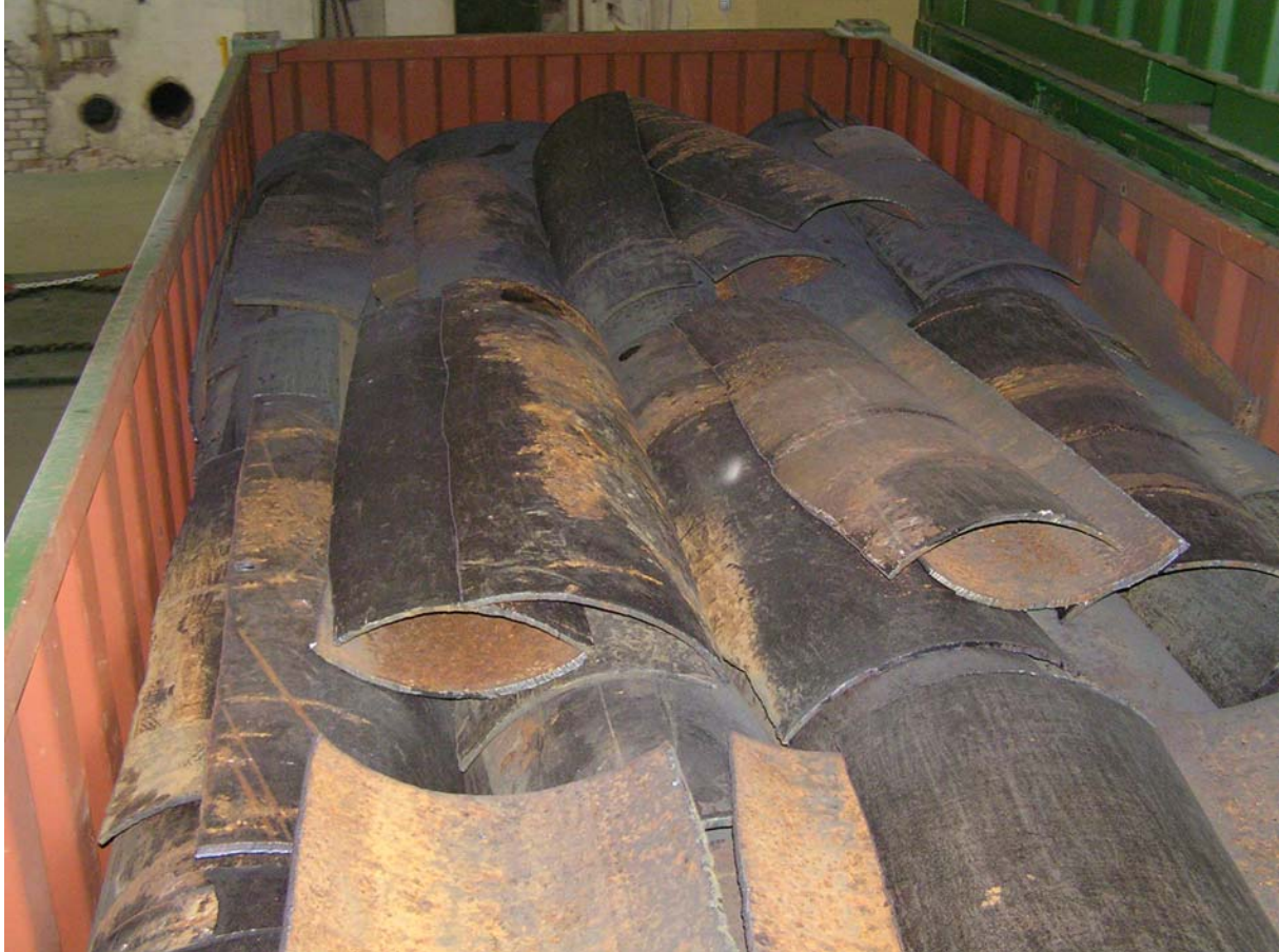
Foto 1; Paldiski objekti saastunud ventilatsioonitorud
