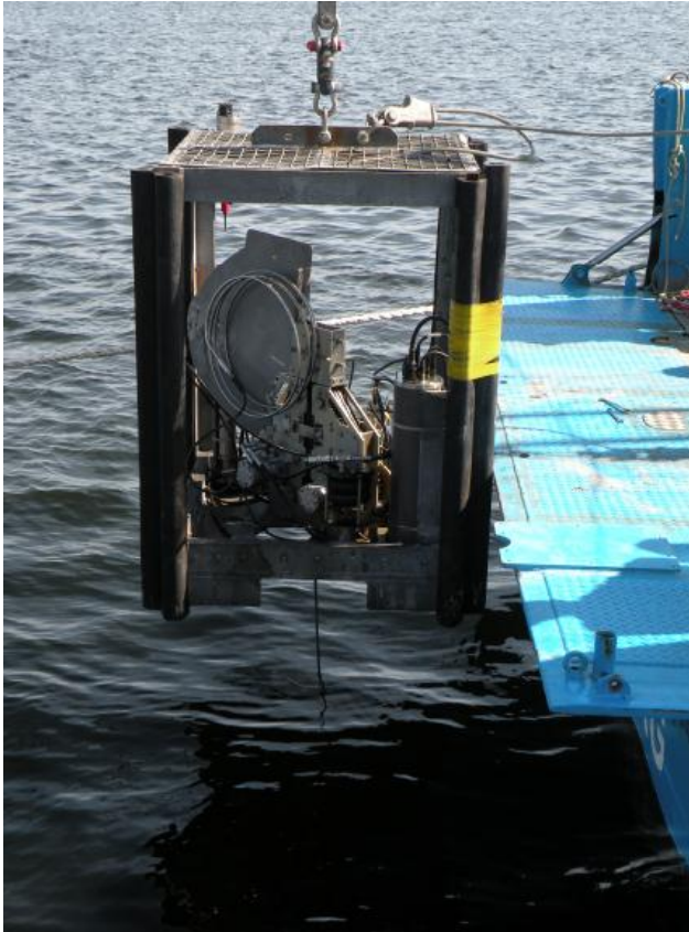
Geotehnilised uuringud Södra Midsjöbankenil, 2011; Foto näitab et CPT seade (Cone Penetration Test) mida kasutatakse maakihtide järjekorra ja maa omaduste näitamiseks.
